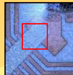
亀裂不良品(顕微鏡で検出)
